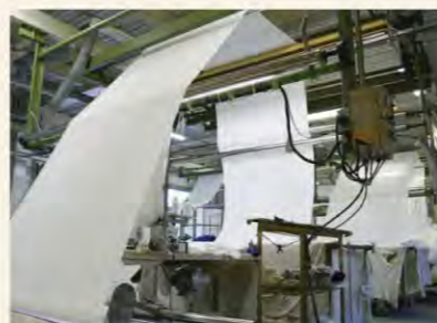
解し機 (編み立てられた生地をつなぎ合わせる機械)
